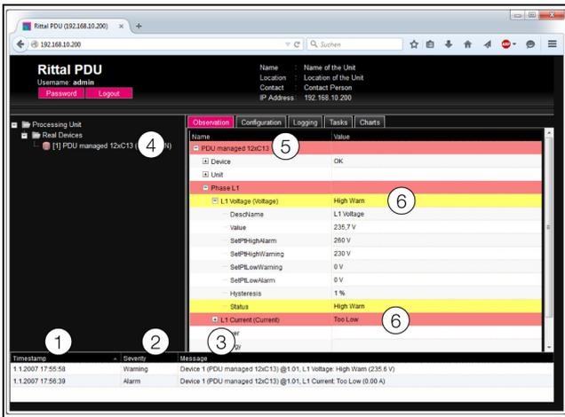
Fig. 28: Layout of message display
